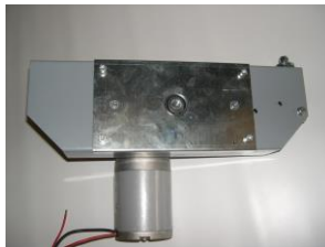
1 Die 4 Schrauben der Schutzabdeckung mit einem 6-mm-Inbusschlüssel aufschrauben
