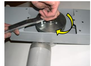
7 Die Griffschraube bis zum Ende anschrauben, eventuell auch mit einem Schlüssel für Sechskantschrauben.
