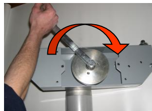
8 Jetzt sind die Antriebswelle und das Untersetzungsgetriebe von der Umlenkrolle entblockt und man kann mit dem manuellen Antrieb der Abdeckung fortfahren.
