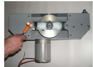
3 Mit demselben Inbusschlüssel beide Schrauben des Verstärkungsbügels der Antriebswelle aufschrauben.
